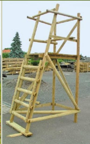
Die wesentlichen Bauteile des Franzosen sind vormontiert. So behalten Sie beim Aufbau die Übersicht. Anzunageln sind noch die Verbindungshölzer. Der Aufstieg ist mit 70° angenehm. Auf eine Zusatzleiter kann verzichtet werden. Der Rundholzdurchmesser von 8cm ermöglicht eine ausgewogene Stabilität ohne den Drückjagdbock fürs Umsetzen zu schwer werden zu lassen. Eine Fußbodenhöhe von 1,70m sorgt für einen Kugelfang. Die robuste Dachvariante hat
